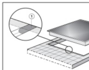
Стыки и заштрихованная область под поверхностью панели конфорок должны быть гладкими и ровными, чтобы панель лежала ровно и уплотнение под кромкой верхней части прибора обеспечивало герметизацию столешницы.
