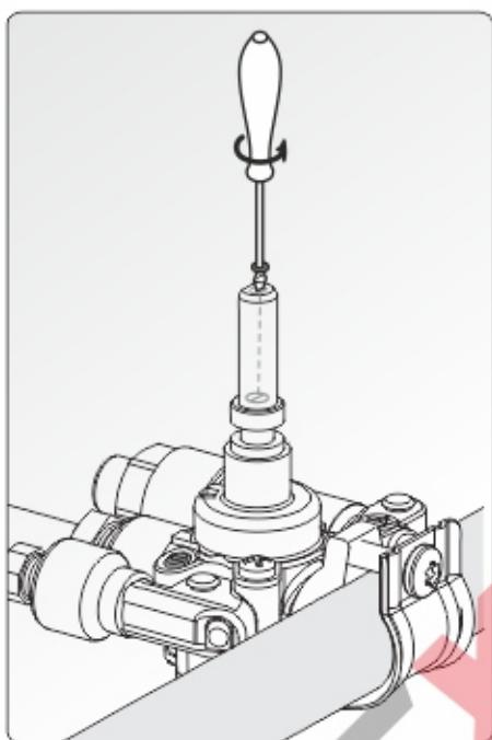
Для того чтобы определить минимальный уровень, зажгите конфорки и оставьте их в положении минимального пламени. С помощью небольшой отвертки затяните или ослабьте **перепускной винт** на 90 градусов. Когда пламя достигает длины не менее 4мм, газ подается нормально. Убедитесь, что пламя не гаснет при быстром повороте регулятора с положения **максимального пламени** на **минимальное пламя**. Создайте рукой движение воздуха по направлению к пламени, чтобы проверить стабильность пламени.
