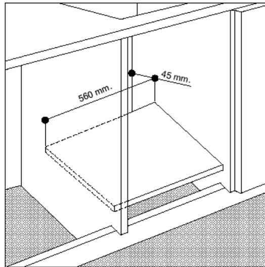
Панели смежных шкафов должны быть сделаны из теплостойкого материала. В частности, шкафы с внешними фанерными деталями должны быть собраны на клею, который может выдерживать температуры вплоть до 100°C.
