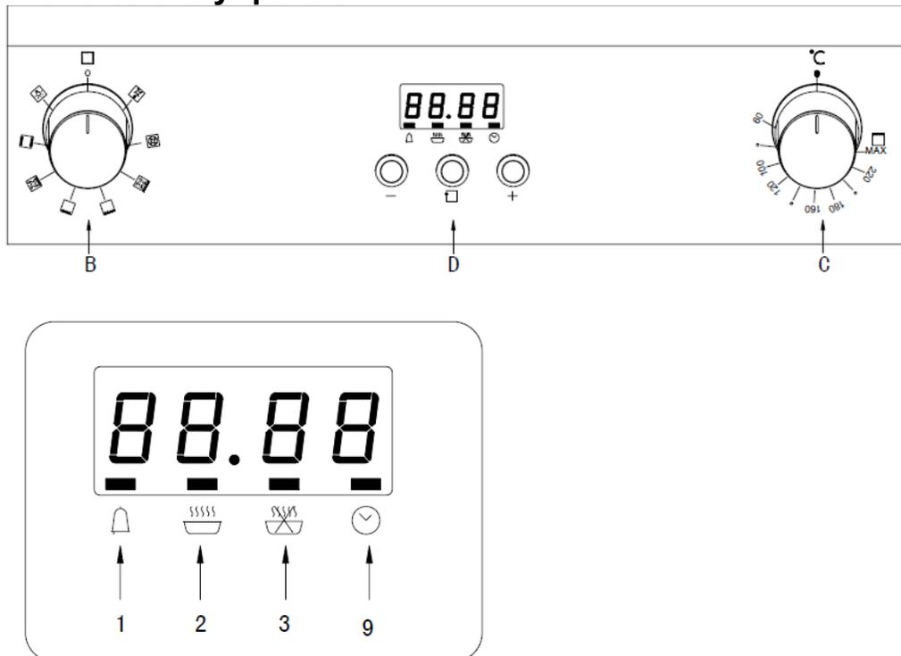
В. Переключатель выбора режима тепловой обработки
