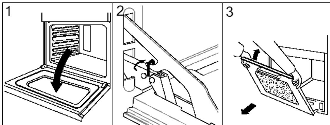
Для более тщательной очистки Вы можете удалить дверь духовки. Выберите метод удаления и сборки согласно различной структуре двери купленной духовки. Действуйте следующим образом:
